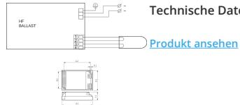
Technische Daten Philips HF-P 1 22-42 PL-T/C/L/TL5C II 220-240V für 1x22-42W
